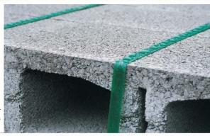
Fita de poliéster aplicada em blocos de concreto.
