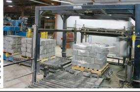
Máquina de aplicação de filme stretch SRA650 com desbobinador superior de cobertura.
