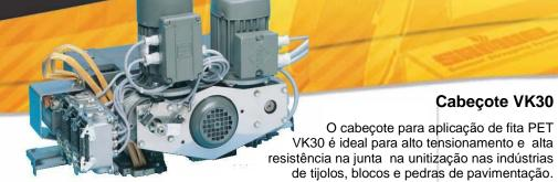
**Alta capacidade de tensionamento** - Permite o uso de fita de alta resistência para aplicações de alto tensionamento que exijam esforço de carga da fita, resultando em maior tensionamento retido sobre o produto.
