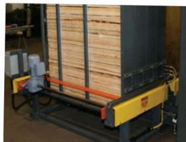
Magazines múltiplos para alojamento dos batoques
