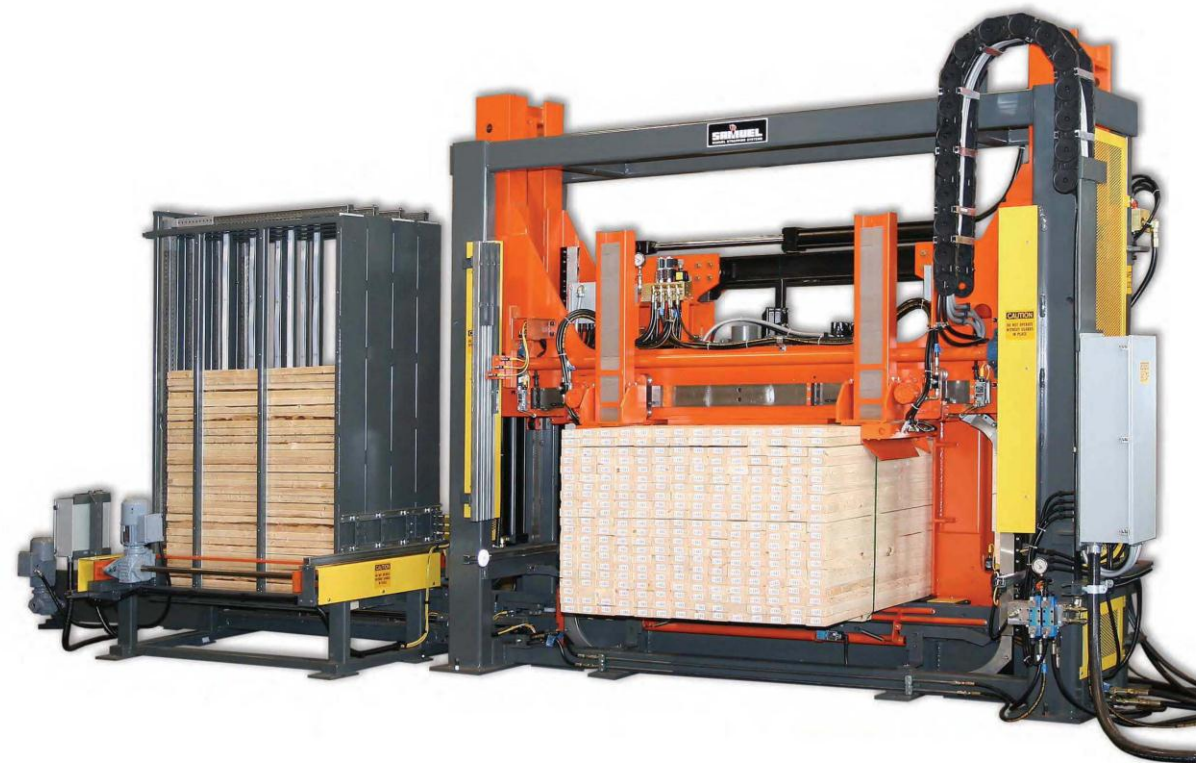
Proteção automática da borda superior e inferior utilizando protetores de borda de placas de fibra planas
