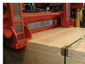
Proteção automática da borda superior e inferior utilizando protetores de borda de placas de fibra planas
